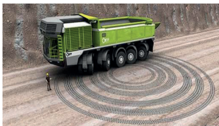
13. ábra A helyben forduló EFT teherautó
