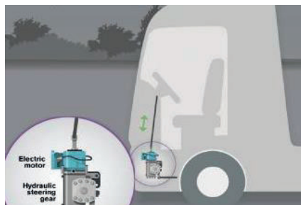
14. ábra A Dynamic Steering elektro-hidraulikus szervorendszer
