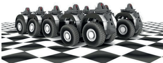
5. ábra A külszíni bányászatban alkalmazott járművek ETF típusú stabilizáló rendszere
