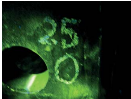
7.7 ábra Repedéshalmaz a vastag szem furatában
