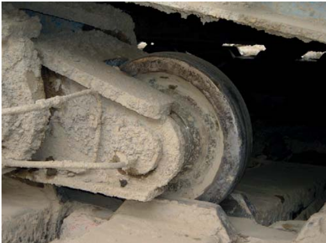
1.2 ábra Járógörgő és láncaltptörzs kapcsolat
