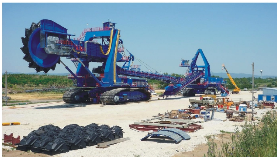
Kompakt kotrógép és ahhoz illesztett szalagkocsi
