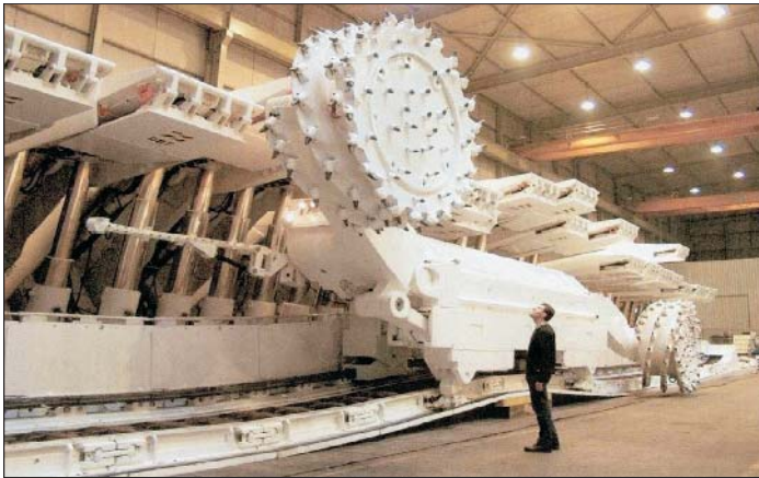
Walzenlader: - Installierte Gesamtleistung 2100 kW - Schneldhöhe 6.0 m - max. Geschwindigkeit 60 m/min - Gewicht 120 Tonnen
