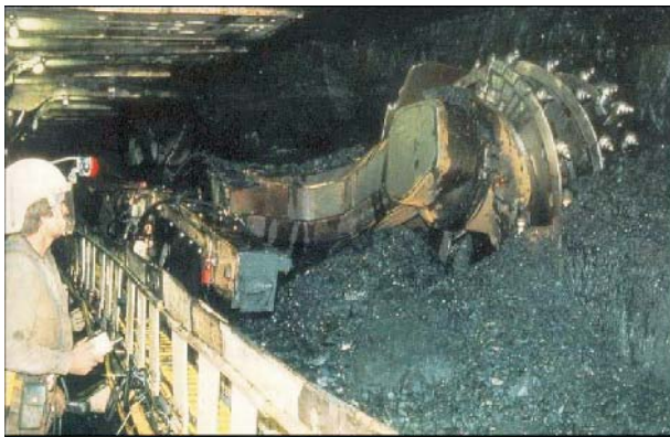
Hochleistungswalzenlader erbringen Gewinnungsleistungen bis 50 000 t/Tg.
