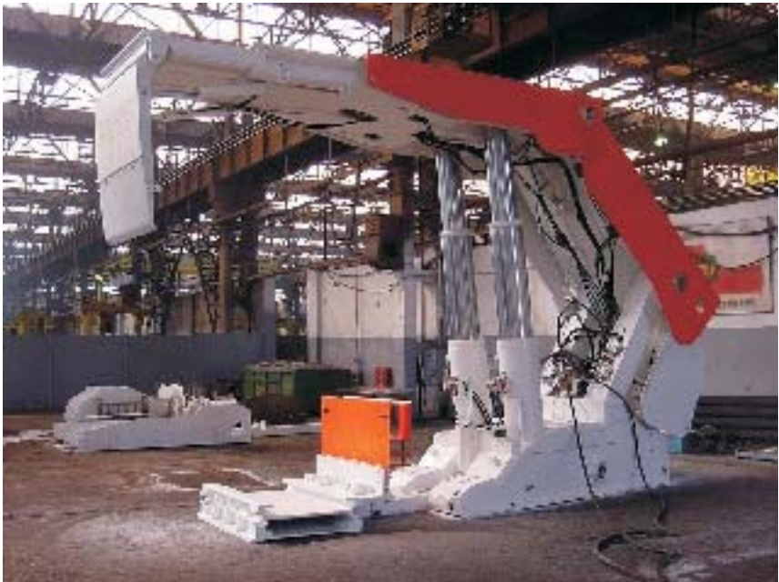
2. kép GLINIK-22/47-POz biztosítás kitolható kistetővel
