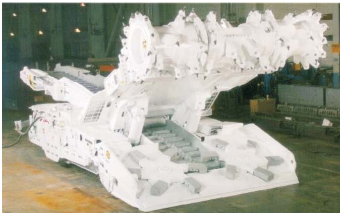
Continuous Miner: Schneidhöhe bis 5.0 m – Gewicht 62 Tonnen Gesamt installierte Leistung 700 kW
